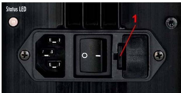
Bild A.5.1: Netzsicherung
