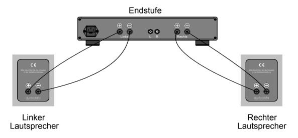
Zeichnung 1.2.1: Lautsprecheranschluß mit Single-Wiring Lautsprecherkabel
