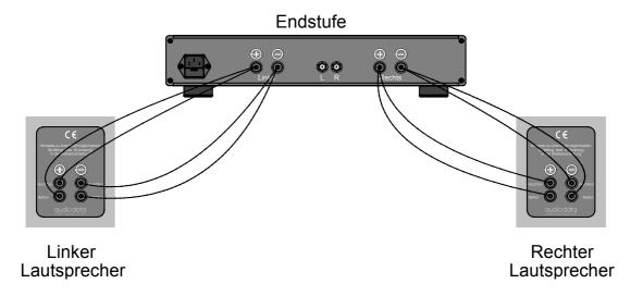
Zeichnung 1.2.3: Lautsprecheranschluß mit Bi-Wiring Lautsprecherkabel
