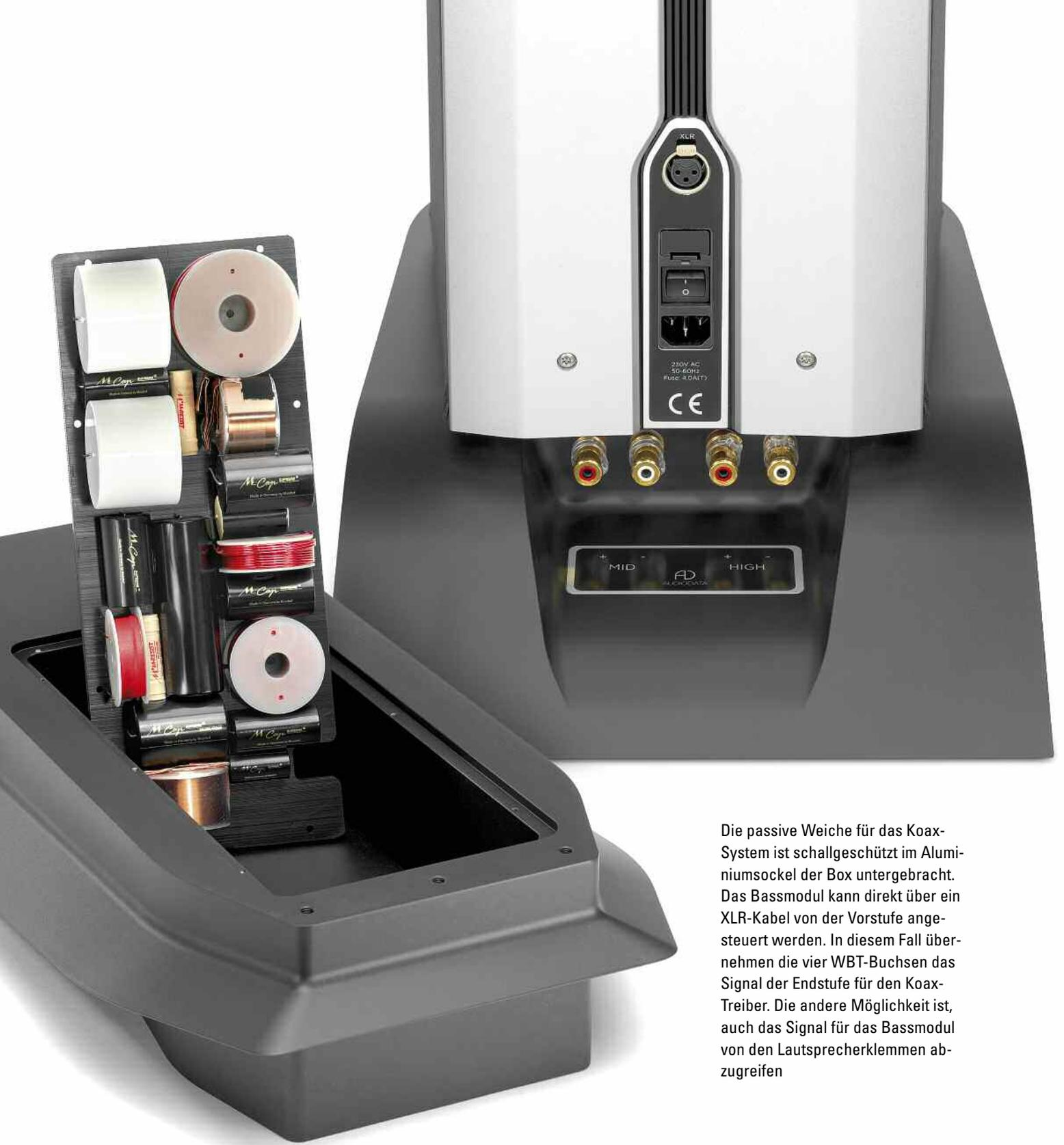
Die passive Weiche für das Koax-System ist schallgeschützt im Aluminiumsockel der Box untergebracht. Das Bassmodul kann direkt über ein XLR-Kabel von der Vorstufe angesteuert werden. In diesem Fall übernehmen die vier WBT-Buchsen das Signal der Endstufe für den Koax-Treiber. Die andere Möglichkeit ist, auch das Signal für das Bassmodul von den Lautsprecherklemmen abzugreifen
