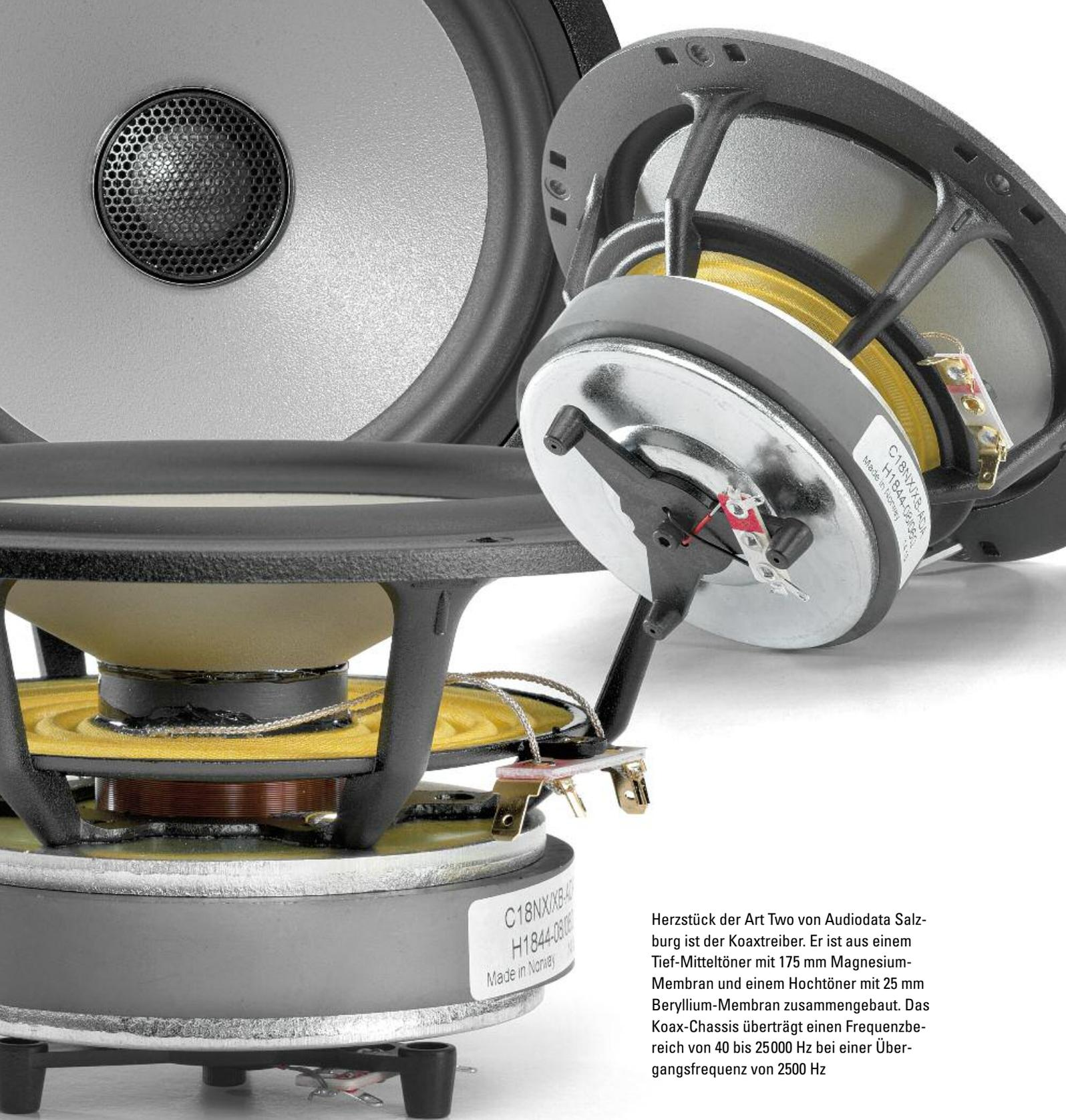
Herzstück der Art Two von Audiodata Salzburg ist der Koaxtreiber. Er ist aus einem Tief-Mitteltöner mit 175 mm Magnesium-Membran und einem Hochtöner mit 25 mm Beryllium-Membran zusammgebaut. Das Koax-Chassis überträgt einen Frequenzbereich von 40 bis 25000 Hz bei einer Übergangsfrequenz von 2500 Hz
