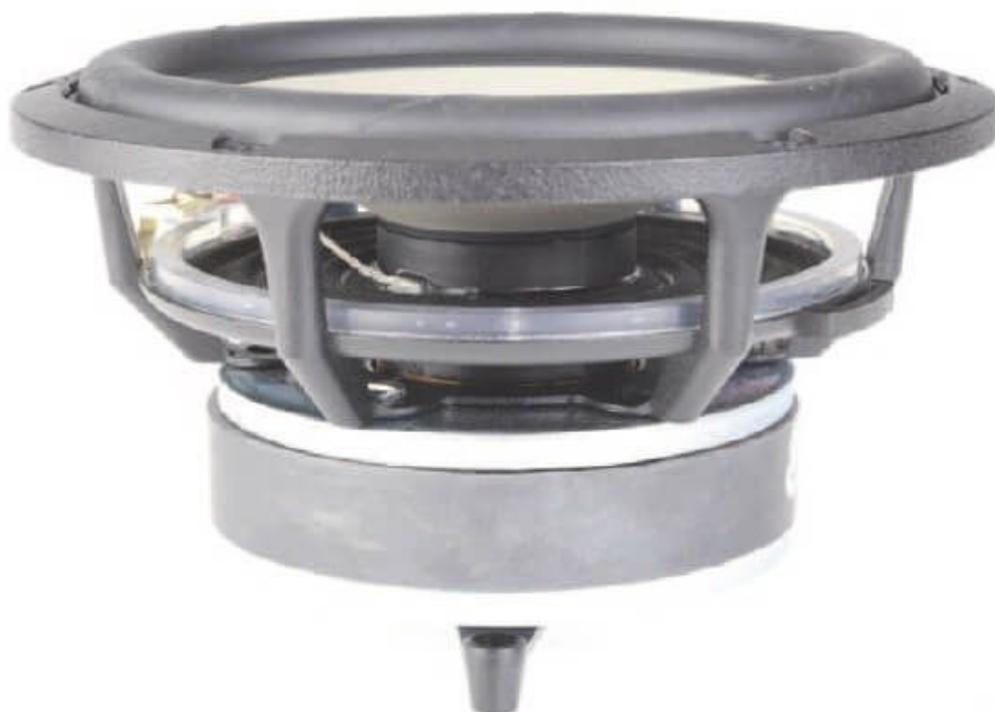
Der filigrane Gusskorb mit großzügiger Hinterlüftung ist noch als Seas zu erkennen. Der Magnesium-Konus mit einer gummiringverstärkten Sicke ist jedoch eine Spezialanfertigung, die edle Beryllium-Kalotte (nicht sichtbar) verbirgt sich innerhalb des Schwingspulenträgers, vorgesetzt vor den Mittelton-Antrieb.
